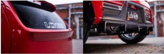
リアのハッチゲートのガラス下に装着するウエストスポイラー。ワイパー穴の有無、カメラ穴の有無が選べるようになっている。
